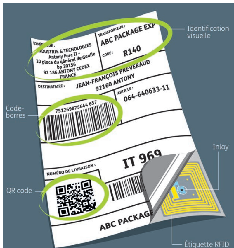
5 L'étiquette intelligente. L'étiquette intelligente ou smart label intègre un inlay RFID dans sa structure. Sa face visible peut comporter des informations alphanumériques lisibles à l'œil ou via un système de reconnaissance optique, ainsi que des codes à barres. L'étiquette est ainsi compatible avec de multiples systèmes de suivi et peut comporter plusieurs niveaux d'information
